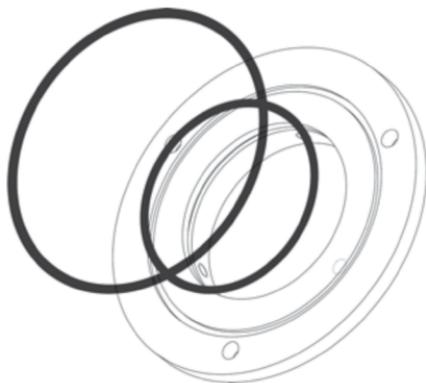
**Figura 18** – Anéis o-ring para instalação do flange
