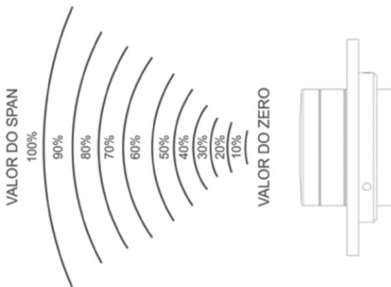
Figura 5 – Escala de detecção em função de Sense
