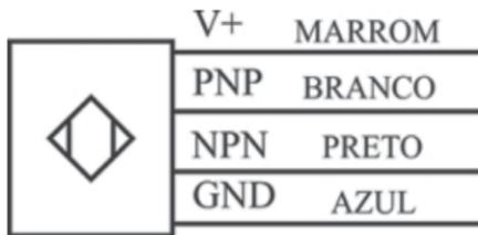
**Figura 14** – Diagrama de conexão
