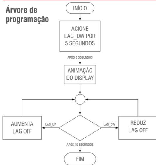
Combinado com o uso do Lag, o Lag Off é uma ferramenta poderosa que evita o falso disparo do sensor. A faixa de valores do Lag Off é de 0 a 3 segundos, com resolução de 0,3 segundos.
